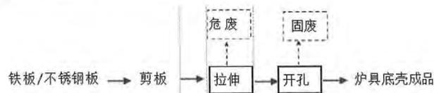
图 3-3 生产工艺及产污环节流程图
