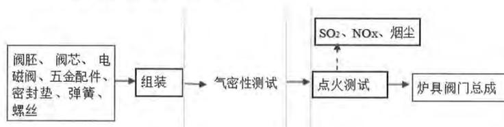
图 3-8 生产工艺及产污环节流程图
