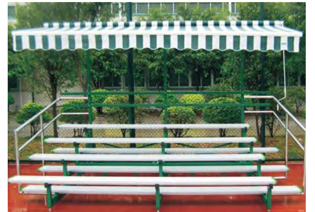
LP-4 四层看台 LP-4 Four-Row Bleacher Without Back 四层看台 4085X2450X1640 平板铝合金座板 240X60X3490 铝合金踏板 240X60X3910
