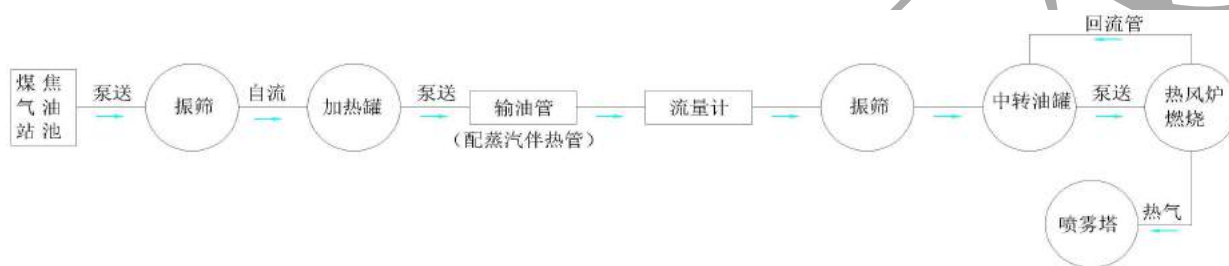
图 4.2-3 煤焦油燃烧处理工艺流程图
