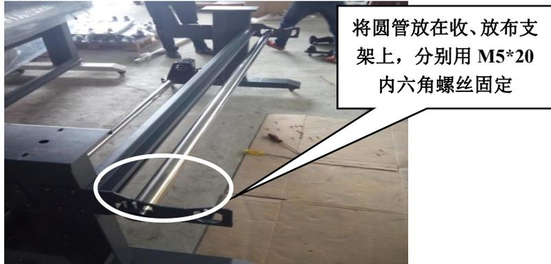
图 1.13 圆管安装示意图 (三)
