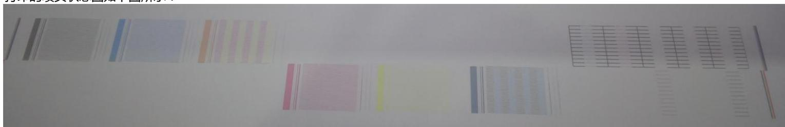
上图是完美的喷头状态图，如出现断针，需清洗喷头，尽量确保喷头状态良好。
