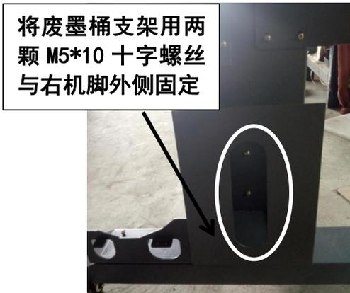
图 1.16 废墨桶支架安装示意图
