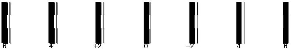
如上图所示,校准图在“-4”为最准,则在双向值编辑框-24 的基础上再减 4,为“-28”,再点击“应用”按钮保存,继续点击“双向校准”确认校准图是否已经校准。
