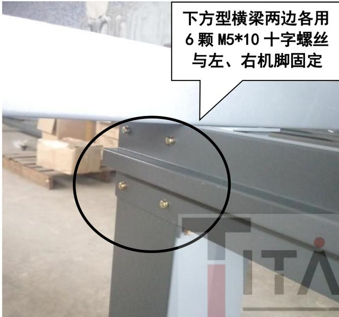
图 1.7 下方型横梁安装示意图（三）
