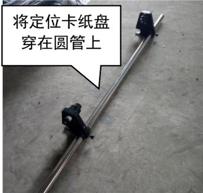
图 1.12 定位卡纸盘安装示意图
