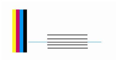
点击步进校准，小车会打印两次，第一次打印会同时打印出几条短线，第二次打印一条长线，第二次打印的长线刚好盖在第一次打印的中间一条线上说明步进值准确，如上图所示
