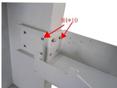
**B:**将定位卡纸盘穿在圆杆上, 分别用 5 颗 M4\*10 十字螺丝钉将抬布方杆、圆杆固定于抬布支架上。
