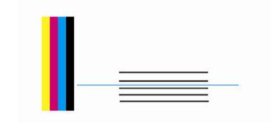
如果第二次打印的长线在第一次打印的中间一条线下方，则说明步进值需要减小，如下图所示
