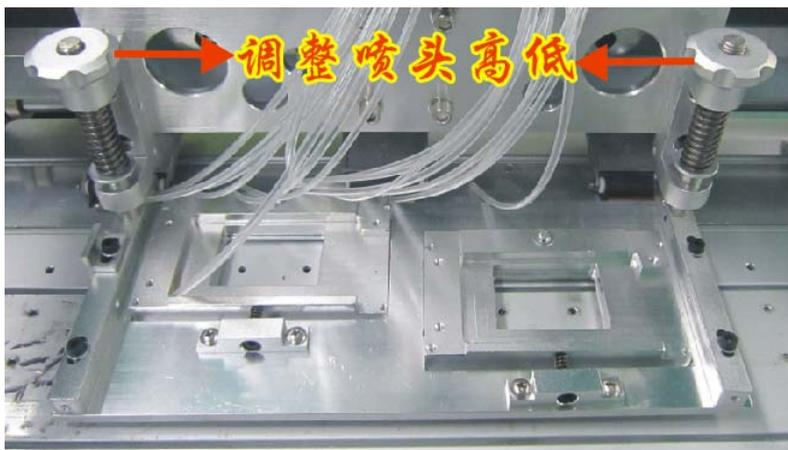
(注意：安装喷头前一定要先用蒙泰软件 RIP 一副 1.5 米 X1 米宽的画面，先试喷完确保机械没什么问题后再安装喷头！)
