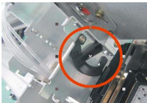
通过上下搬动来对喷头进行校准，调整到喷头能喷出下图效果完成校准！红线跟青线在同一水平线上
