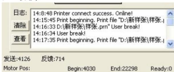
显示文件什么时间开始打印，什么时间结束以及主板、软件的发送信息，光栅解码器的反馈信息。
