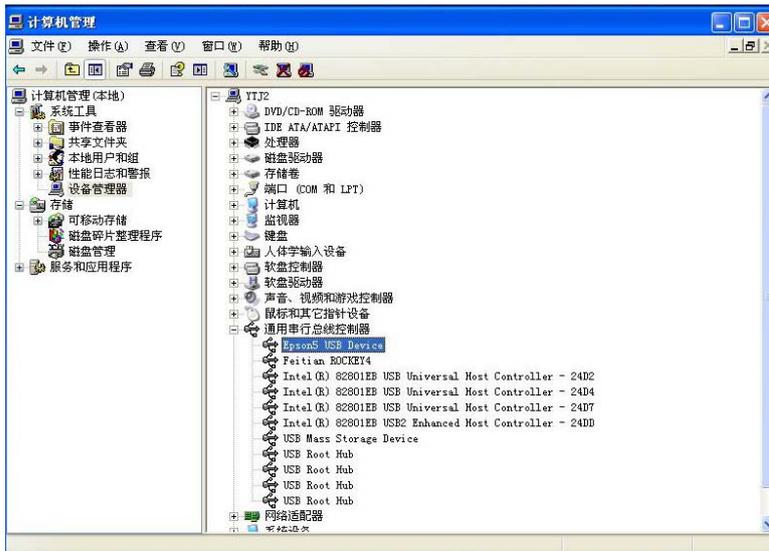
如果电脑里面没有显示上图所示的“Epson5 USB Device”或者是“Epson5 USB Device”带有问号，表示驱动没有安装成功。
