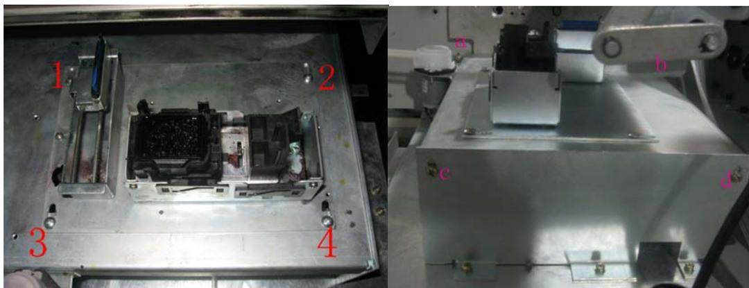
C、墨泵能很顺畅的抽出墨后，（墨泵工作的电压可以从控制软件---调试工具里面进行更改，一般建议 6V---13V 电压！）关电，按下图指示把喷头数据线接在转接板上然后插在头板上
