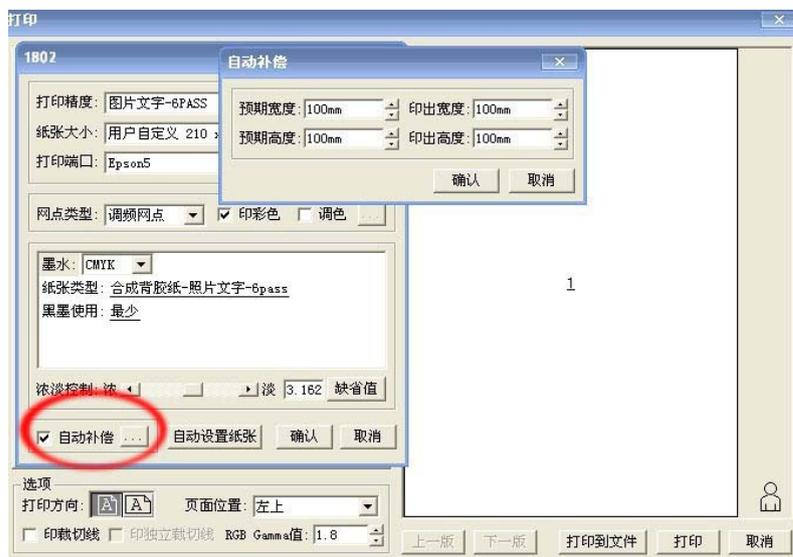
例如：设计一副（预期宽度\*预期高度=100mm\*100mm）图片，而实际（印出宽度\*印出高度=100mm\*110mm），那么您只需在自动补偿对话框中把印出高度 110mm 输入，点击确定，软件就自动保存了您的设置。
