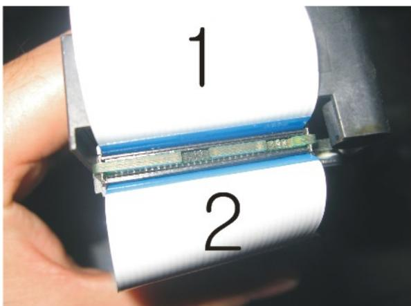
每个喷头有八列喷孔，每列喷孔都有一个专门进墨水用的进墨嘴。每个喷头都有两个插喷头扁平线的接口，如下图所示
