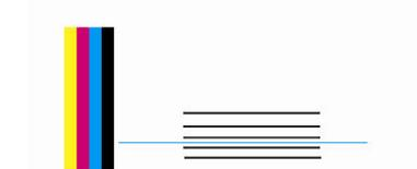
使用者根据自己的实际情况来调试，直到第二次打的长线刚好盖在第一次打印的中间一条线上为止。
