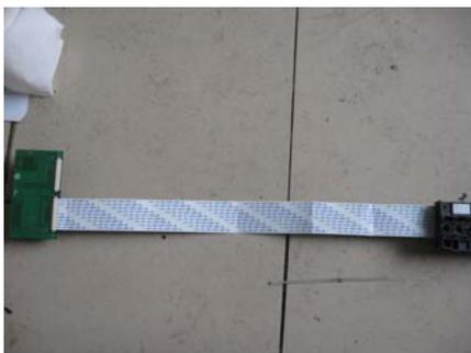
开电前一定要再次确认喷头数据线接的完全正确，检查无误后，开电，用控制软件打印测试条，没有丢线的情况下为最好状态，如下图所示
